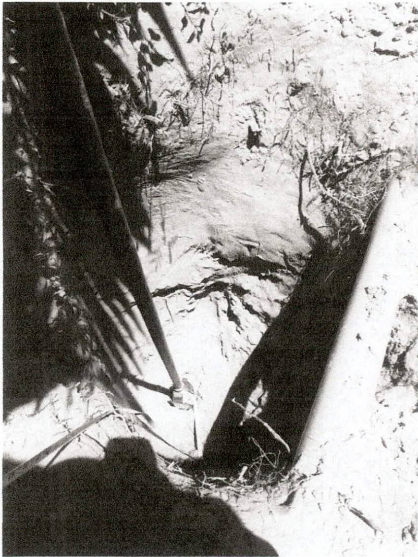
FOTO N° 02: Calicata C - 1, Se puede observar la presencia de malesas (raíces de las plantas)
