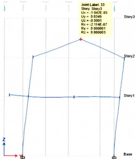
En la figura se muestra el desplazamiento máximo en el primer nivel 0.0172 cm
