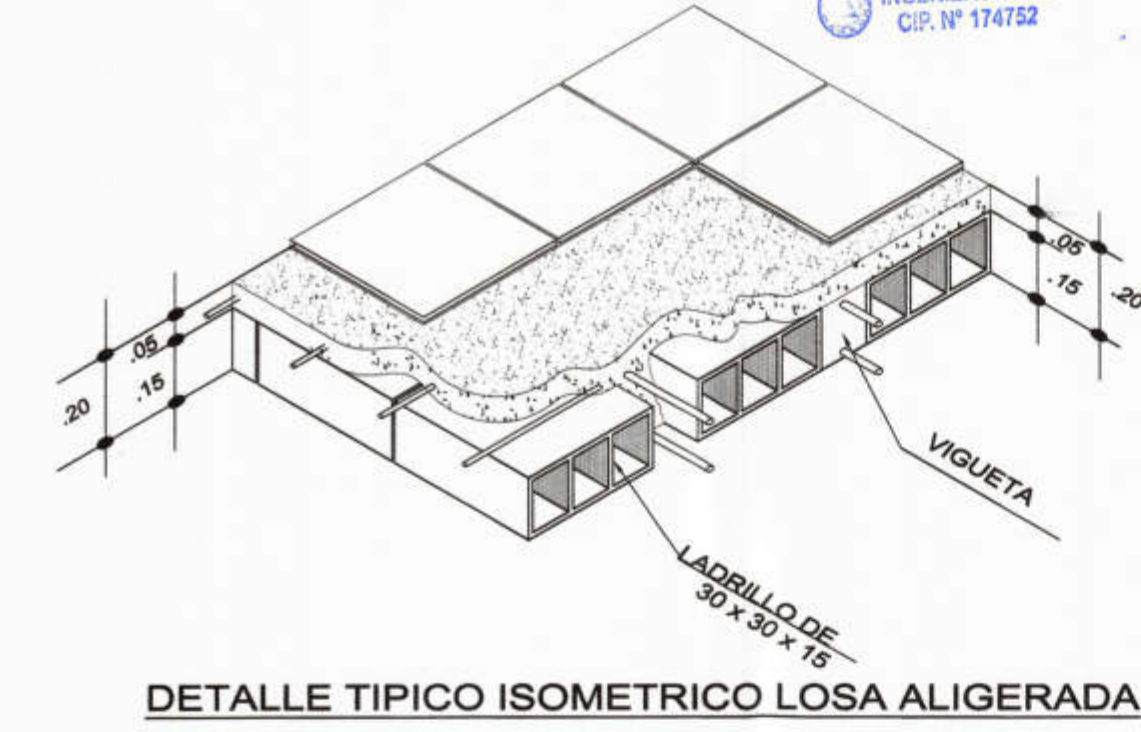
DETALLE TÍPICO ISOMETRICO LOSA ALIGERADA
