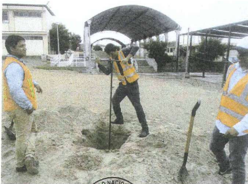
CALICATA N° 03 – REALIZANDO MUESTREO CON BARRENO
