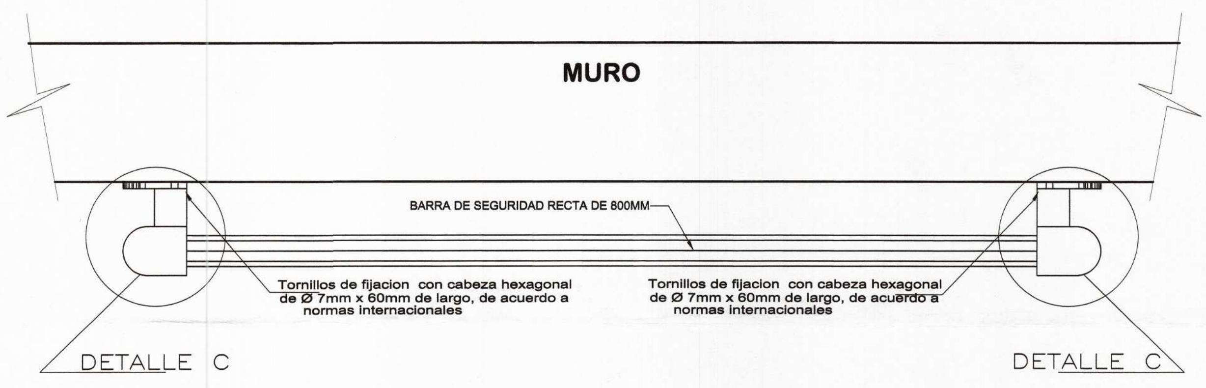
PLANTA: SOPORTE DE PASAMANO PARA DISCAPACITADOS ESCALA : 1/10
