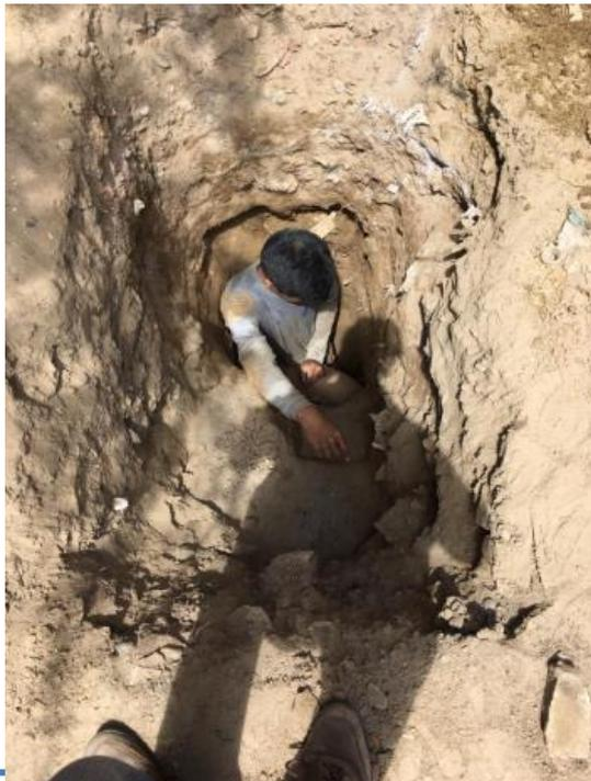
Se realiza la exploración de calicata escalonada a tajo abierto usando herramientas manuales, esto debido a las condiciones del suelo a explorar.
