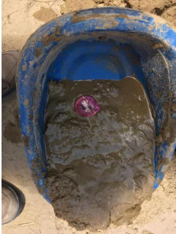
Se puede apreciar que las muestras representativas se encuentran completamente saturadas porque el nivel de la napa freática se encontró a los 2.0m de profundidad y la muestra extraída se obtuvo a los 3.0m de profundidad.
