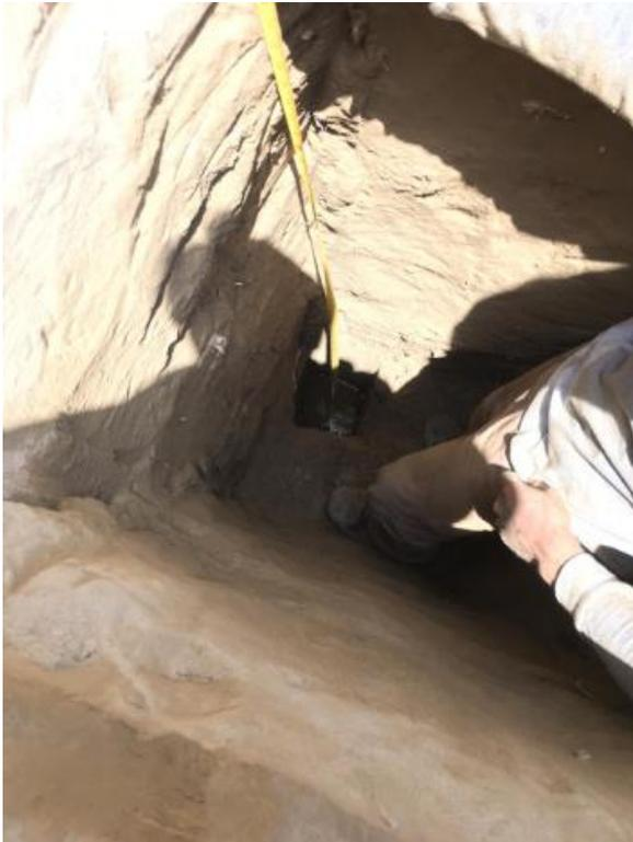
Se evidenció la presencia de napa freática en la Calicata N°01 a una profundidad de 2.00m desde el nivel de terreno natural. Este dato es importante en la determinación de la capacidad portante del suelo de cimentación.
