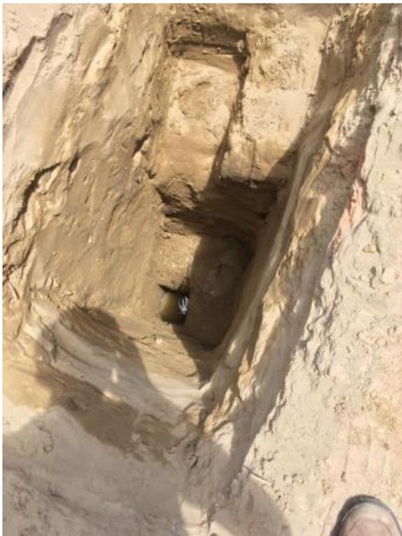
Se encontró en la Calicata N°01 presencia de capa freática, la misma que debe de tenerse en cuenta en el momento de realizar el diseño estructural de la cimentación.
