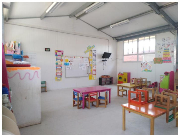
Foto N°01 Se aprecia piso vinílico, estructuras de metal, muros metálicos, ventanas de plástico y vidrio, puerta de metal. Su estado es bueno.
