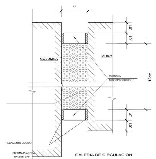
**4 DETALLE TAPAJUNTA COLUMNA-ALFEIZAR**
