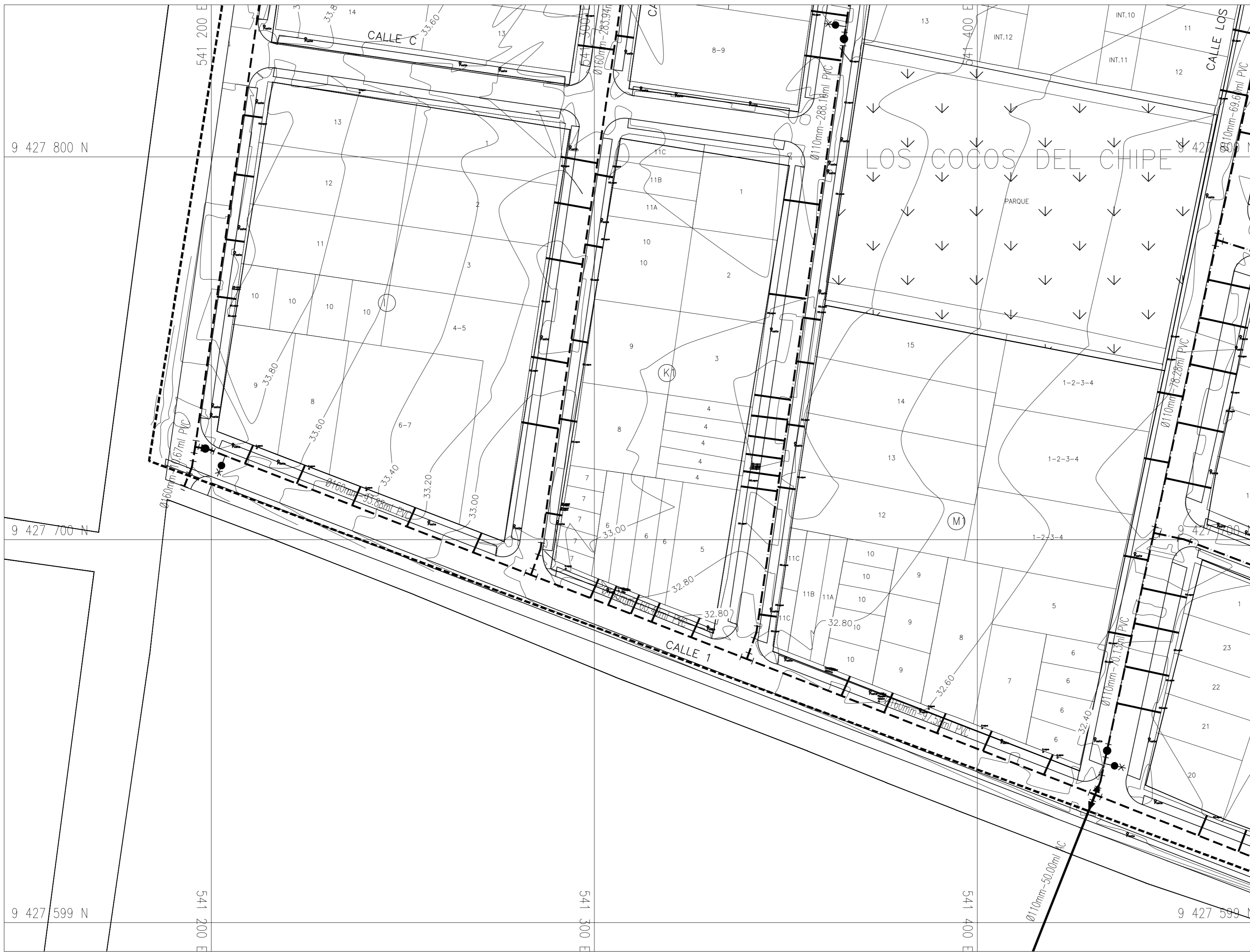
PLANO: CONEXIONES DOMICILIARIAS AGUA POTABLE PROYECTADO ESC.:1/500
